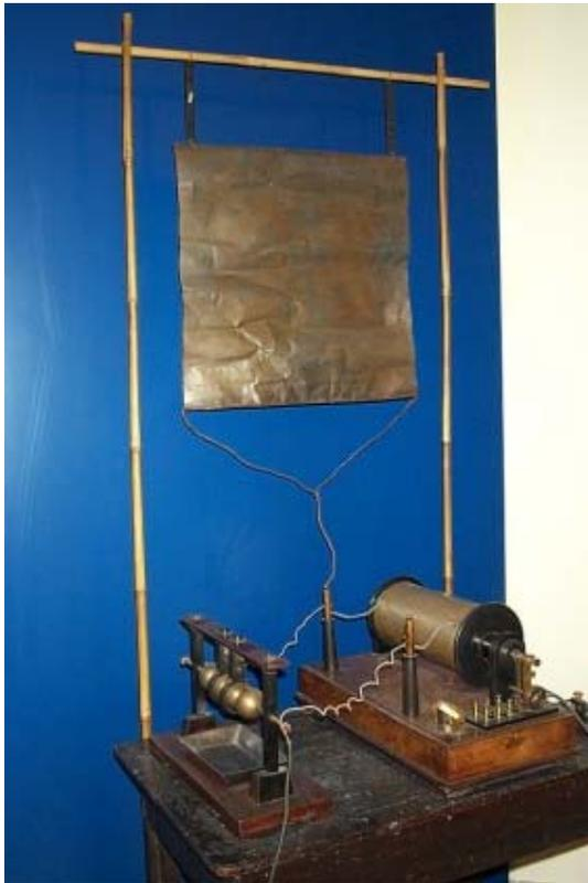
Si accorse che i risultati sulla portata miglioravano se venivano aumentate le capacità su cui terminavano i conduttori sia dell'oscillatore che del coherer; per questa ragione, cominciò ad utilizzare grandi superfici metalliche connesse ai due poli dell'oscillatore, come lastre di ferro zincato (vedi foto a lato, Museo Marconi, Villa Griffone di Pontecchio Marconi - Bologna).
