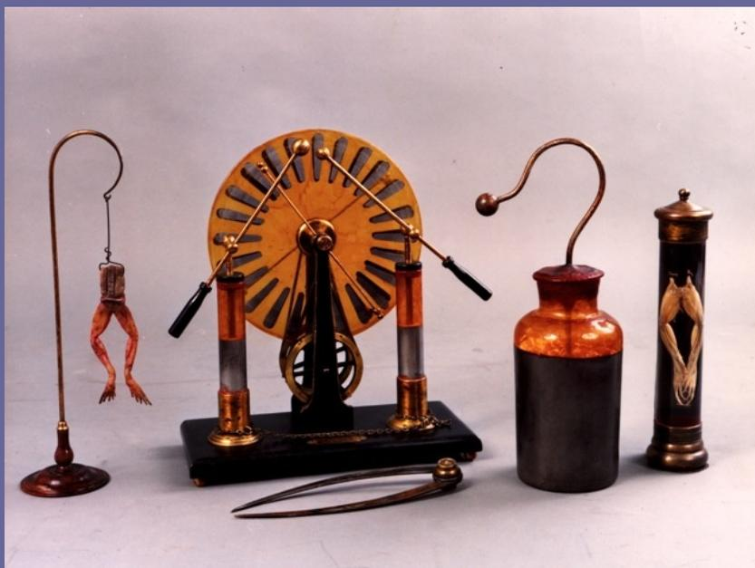
Rana, compasso di rame-zinco e altri strumenti per la sperimentazione della cosiddetta “elettricità animale” di Luigi Galvani, fine Settecento.
