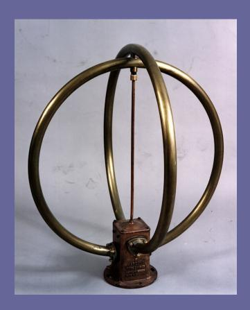
Tipo di antenna installata a bordo dello yacht "Elettra" per esperimenti di radionavigazione, anni Trenta.
