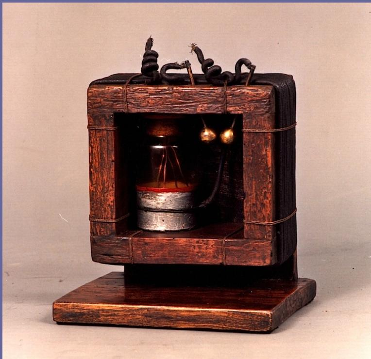
Primo brevetto del sistema sintonico Marconi siglato n. 7777, composto da una capacità elettrica e da un'induttanza, 1900.
