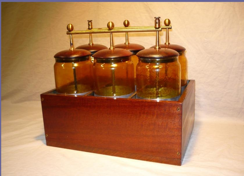
Classica cassetta bottiglie di Leida (condensatori) impiegate da Marconi nella trasmissione sintonica (brevetto n. 7777), inizio Novecento.
