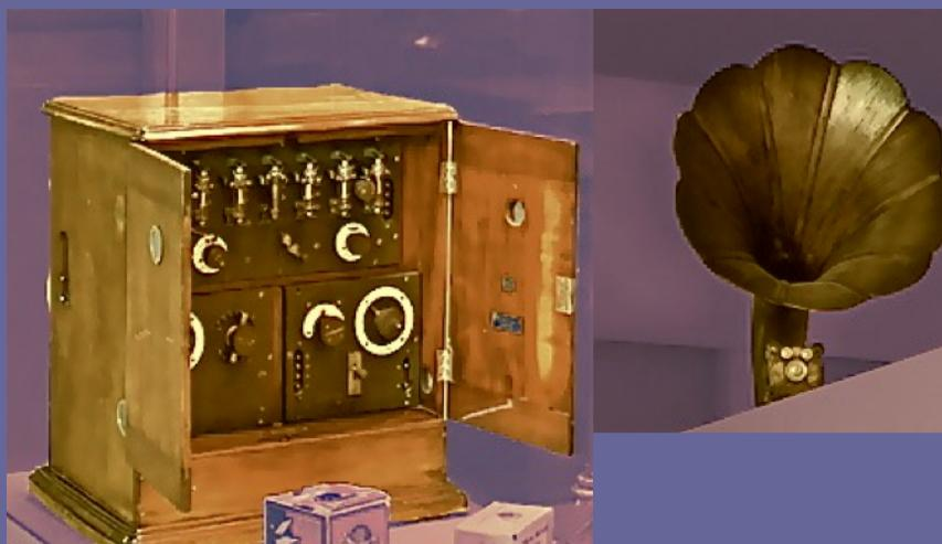
Ricevitore modello Magnus a 6 valvole con auricolare telefonico monoascolto ad alta resa e altoparlante elettrodinamico a tromba di legno, RTM Marconi Genova, inizio anni Venti.
