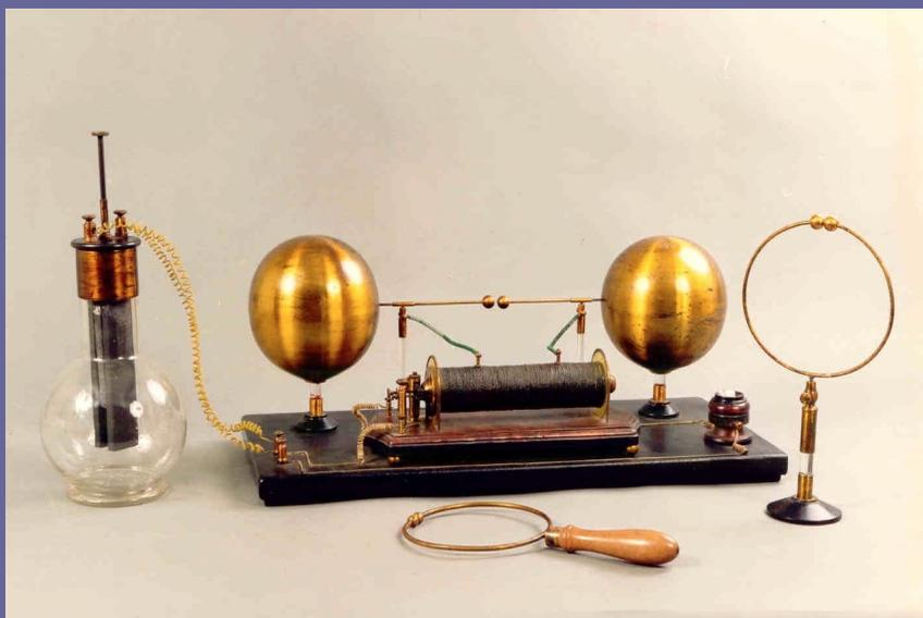
Oscillatore di onde elettromagnetiche a quattro sfere di Heinrich Hertz, 1887.
