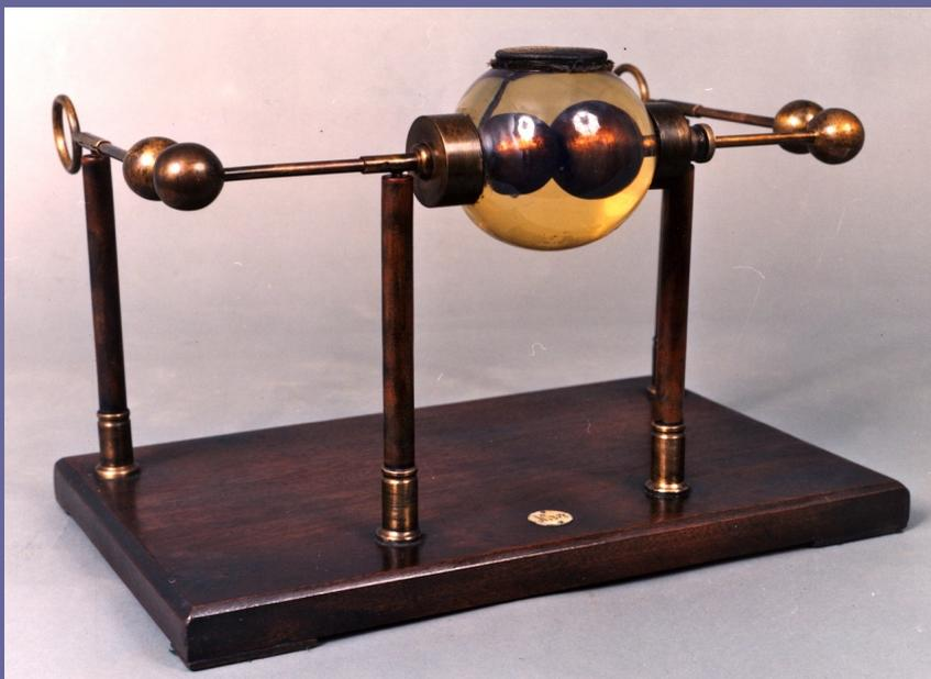
Oscillatore rettilineo a quattro sfere tipo Righi, 1893.
