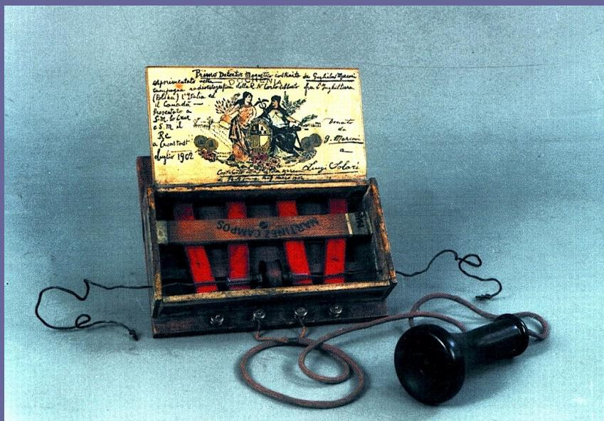
Detector magnetico (ricevitore) ideato da Marconi, che ne realizzò il prototipo utilizzando una scatola di sigari, 1902.
