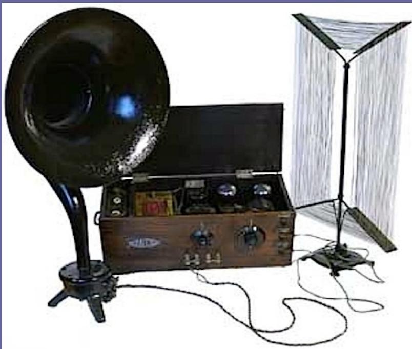
Radoricevitore “Milan Radio” per onde persistenti con circuito a reazione impiegante due triodi a riscaldamento diretto, prodotto a Milano, 1925-1928.
