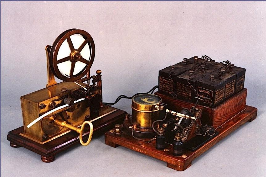
Ricevitore a coesore usato da Marconi nelle esperienze radiotelegrafiche del canale della Manica, 1899.
