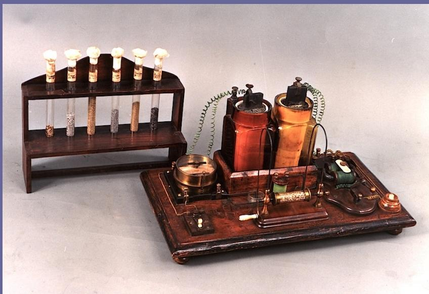
Apparecchio usato da Temistocle Calzecchi Onesti per le esperienze sulla conduttività delle limature metalliche, 1884.
