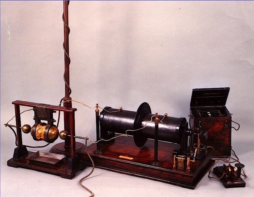
Trasmittitore a scintilla realizzato da Marconi per i primi esperimenti di radiotelegrafia, sperimentato nel canale di Bristol e poi a La Spezia, 1897.
