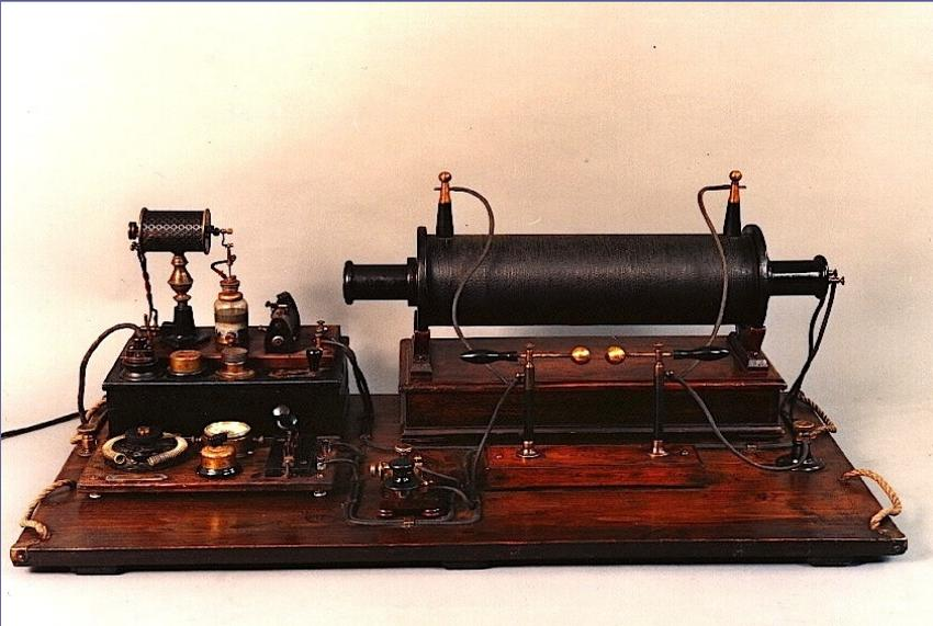
Trasmittitore a scintilla per onde smorzate realizzato nei laboratori elettrici di San Bartolomeo a La Spezia secondo gli schemi lasciati da Marconi, 1898.
