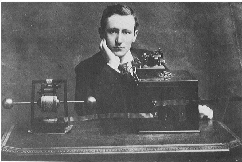
Marconi, 22 anni, come appariva a Londra nella primavera del 1896. Il generatore del codice Morse e due fili di rame usati come antenna ricevente si trovano sulla famosa “black box” a destra contenente il *coherer* mentre a sinistra si vede l'oscillatore a dipolo di Hertz.
